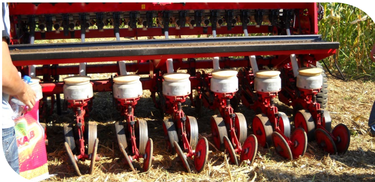
Máquina de semeadora com caixas para sementes de capim sendo utilizada no campo.
