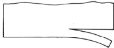
Fig. 1.16 - Flexão da chapa devido a um ângulo de cunha \beta da faca pequeno.
