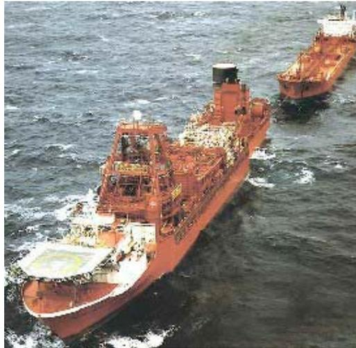
**Figura 6.17 FPSO com o navio aliviado conectado (direita) durante operação de descarga**
