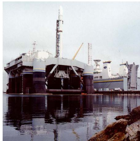
**Figura 1.4** Plataforma de lançamento de foguetes em alto-mar (extraído de Sea-Launch, 2002)
