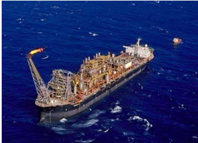
Figura 6.16 FPSO P-37, com *turret* instalado próximo à proa (extraído de Petrobras, 2002)
