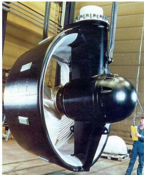
**Figura 3.25 Propulsor azimuthal montado em bocal (extraída de Marine Propulsion International, 1998)**
