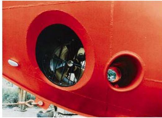
**Figura 3.24 Propulsor em túnel (extraída de Schottel, 2002)**
