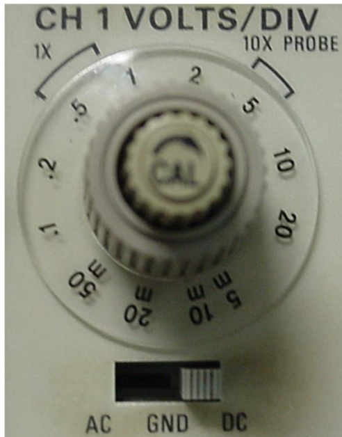
Figura 3 – Botões de seleção: (a) Escala vertical; (b) Base de tempo
