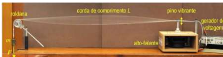
Figura 0.3 - Dispositivo para a geração de ondas estacionárias em uma corda com os extremos presos. Na imagem é mostrada a excitação do modo fundamental n=1 .
