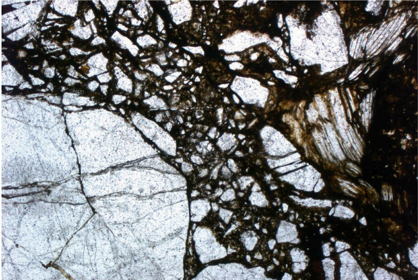
Transição de uma rocha fraturada (canto inferior esquerdo), passando por uma microbrecha de falha (centro) até um cataclasitos contendo micas (superior direito). Largura foto: 3mm
