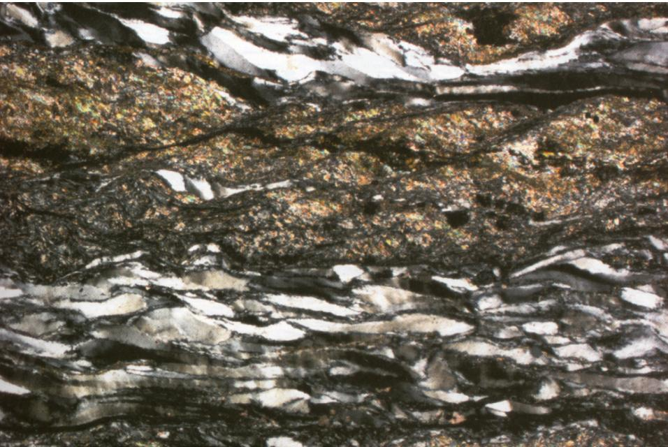
Fitas de quartzo com extinção ondulante e bandas de deformação cristal-plástica. Cristais de biotita da matriz estão intensamente reduzidos.
