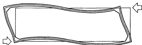
Deformación bajo carga horizontal
