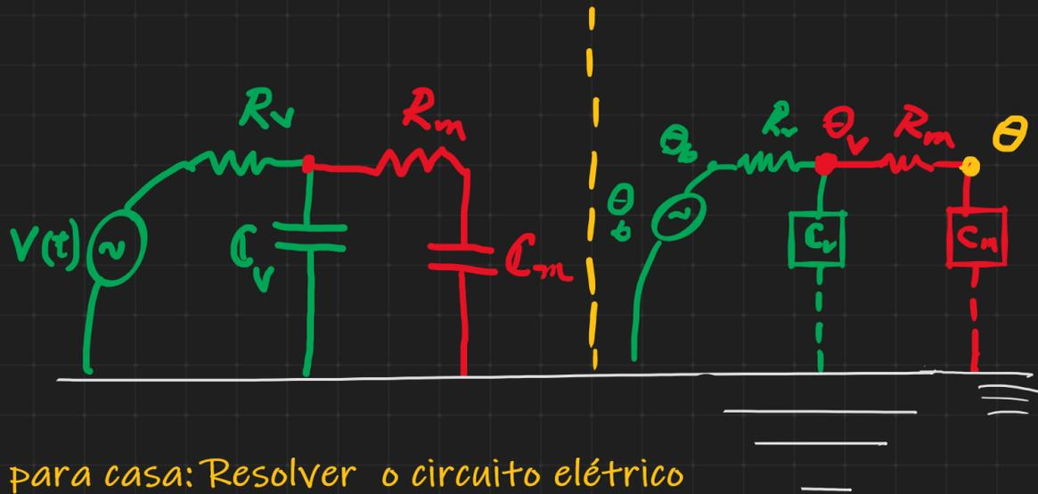
Exercício 3 para casa: Resolver o circuito elétrico e por analogia obter as equações da dinâmica do termômetro
