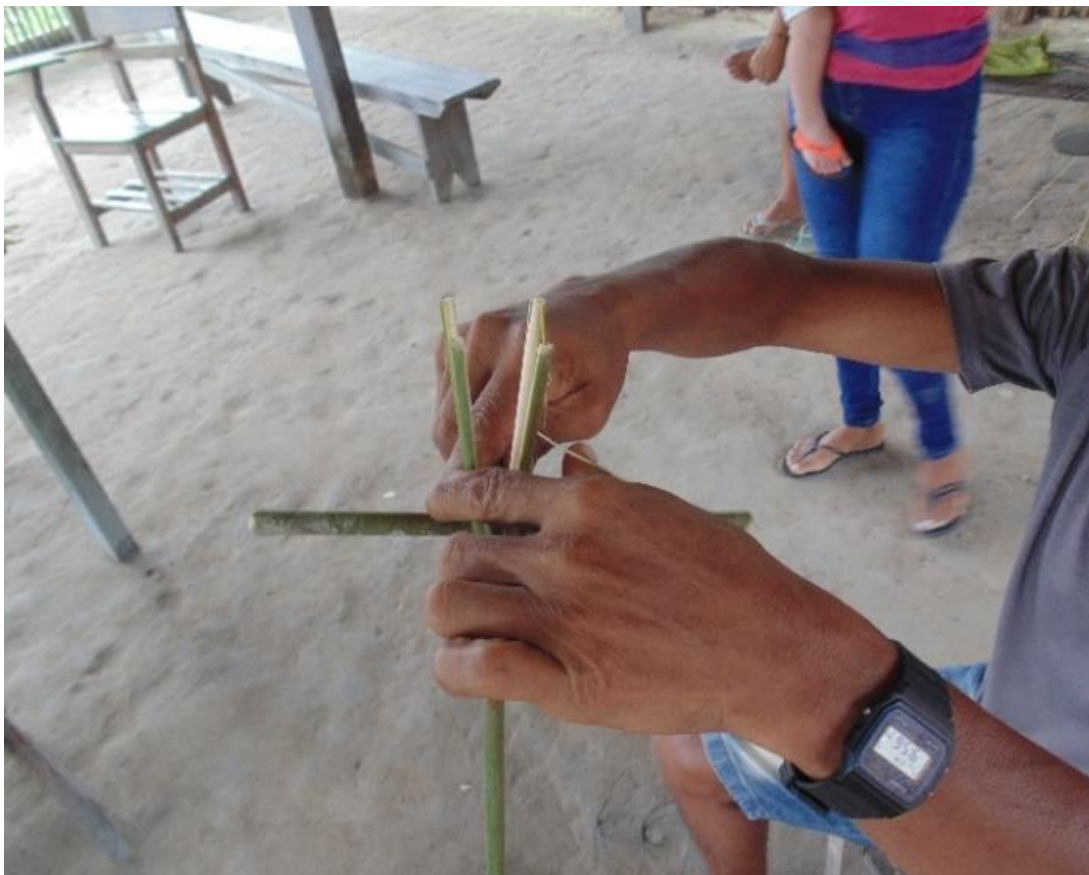
Figura 34 – Com ajuda de um pedaço de pau o arumã é dividido em quatro partes iguais. Fonte: Autora
