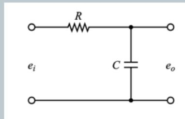
Figura:  $e_i$  e  $e_o$  denotam tensões,  $R$  e  $C$  resistência e capacitância resp/te.
