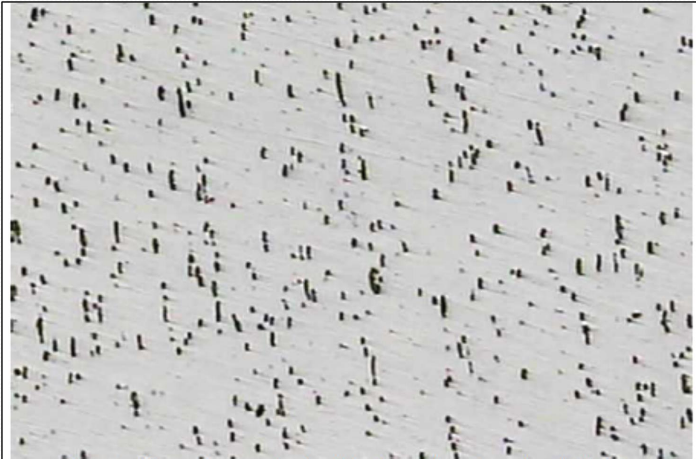
Figura 4 – Micrografia apresentando sulfetos tipo médio curto com boa distribuição.
