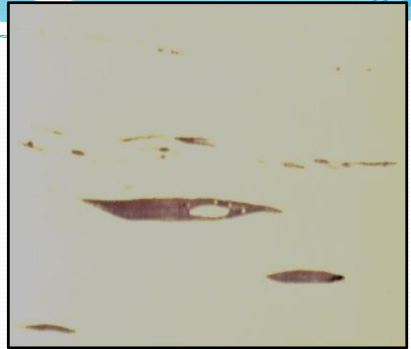
INCLUSÕES DE SULFETO- 1000X
