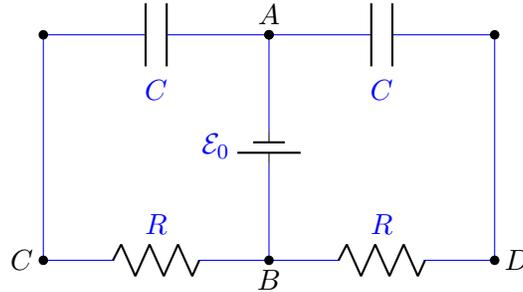
No regime estacionário, ainda podemos utilizar o método das impedâncias, e no fim utilizar o limite  $\omega \rightarrow 0$ . Basicamente, são duas malhas iguais com impedâncias  $Z$  em série:
