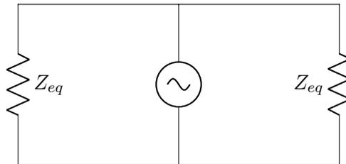
São basicamente dois resistores em paralelo, e então a impedância final se torna
