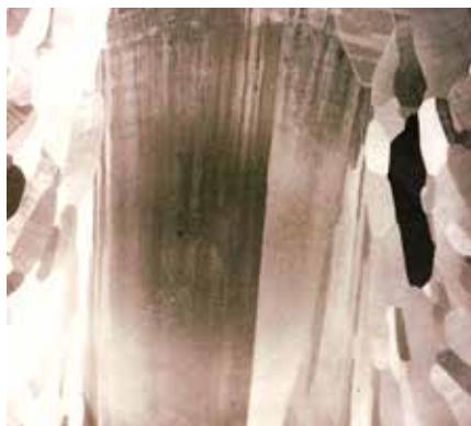
Figura 5 | Corte longitudinal do lingote, produzido pela nova rota, apresentando estrutura praticamente monocristalina no centro. Fonte: [2]
