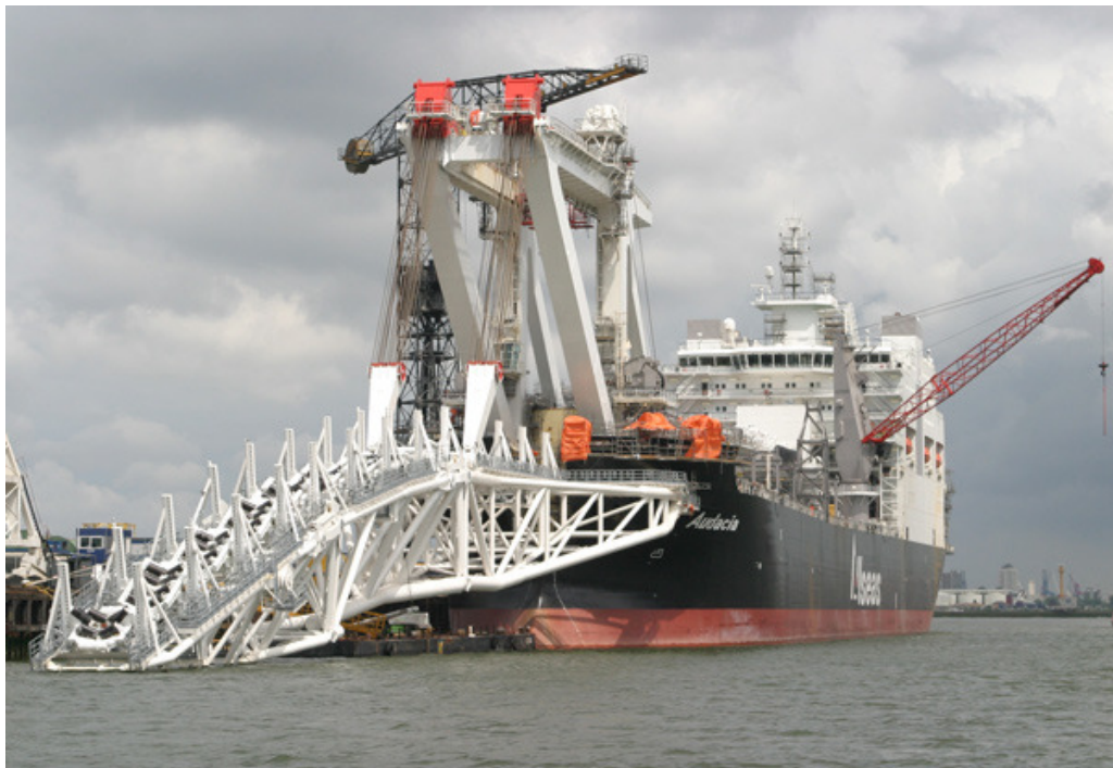
Figura 1.1- Embarcação tipo Pipe Layer Supply Vessel (fonte: www.maritimejournal.com )
