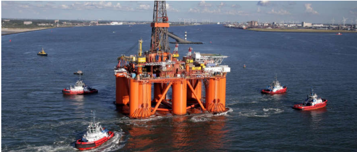
Figura 12: Ilustração de Atividade de Estabilização de Plataforma que Exige a Presença de 4 Navios (ROTOR TUG, 2017)
