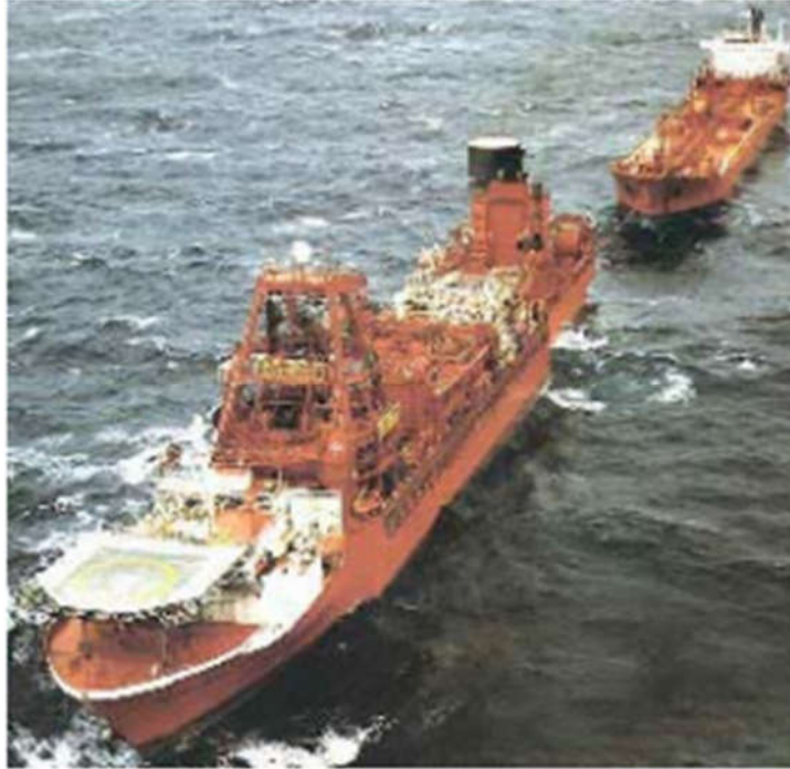
Figura 5: FPSO com navio garantindo distância segura durante operação de descarga (TANNURI et al., 2009)
