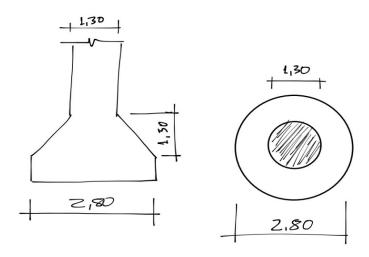
Na execução deste tubulão deve-se aplicar ar comprimido visto que o nível de água esta a 1,0 m de profundidade. Além disso deve-se realizar o encamisamento do primeiro metro em virtude da presença de entulho com pedras e areia.
