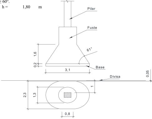
OBS: Caso não fosse possível manter o centro de carga do pilar alinhado ao centro de carga do tubulão, seria necessário calcular uma viga alavanca.
