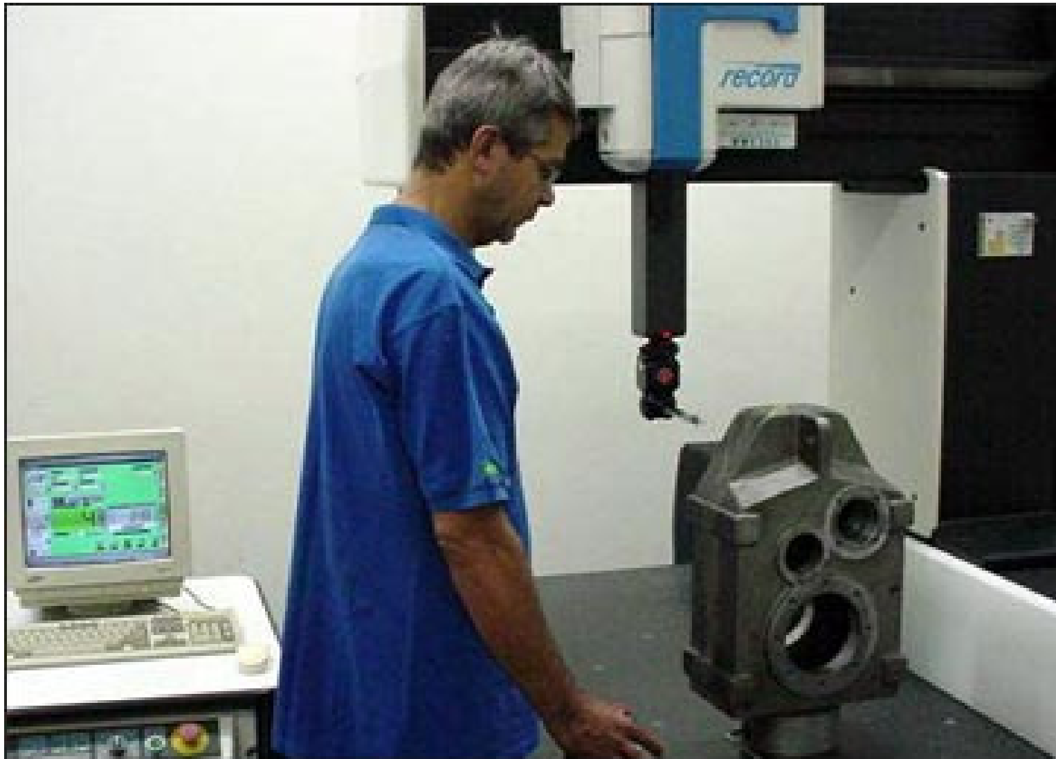
Operação de Máquina de Medição de Coordenadas CMM)
