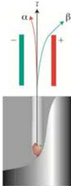
**FIGURA 17.4** Efeitos de um campo elétrico sobre a radiação nuclear. A direção do desvio identifica os raios  $\alpha$  como tendo carga positiva, os raios  $\beta$  como tendo carga negativa e os raios  $\gamma$  como não tendo carga.
