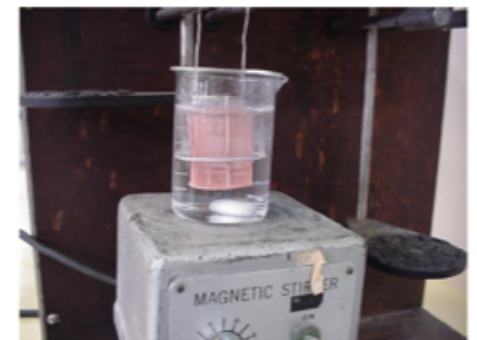
Fim da eletrólise de cobre
