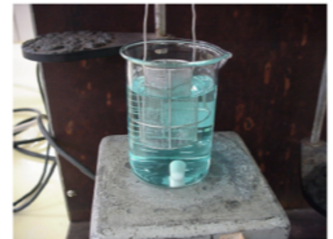
Início da eletrólise de Cobre
