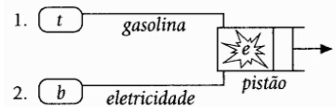
No circuito 1, a gasolina deve sair do tanque t e chegar até a câmara onde se dá a explosão e, em virtude da fâisca elétrica.
