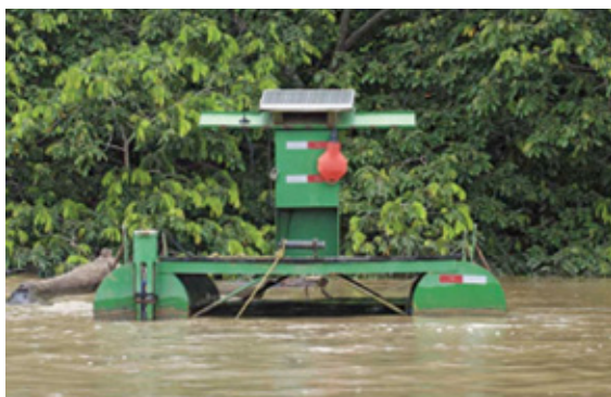
Figura 19.1: Estação de monitoramento automatizada.
