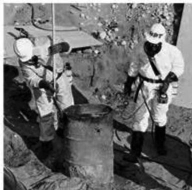
FIGURA 17.30 Este tambor com resíduos radioativos, de 35 anos de idade, sofreu corrosão e o material radioativo vazou para o solo. O tambor estava armazenado em um dos depósitos de resíduos nucleares do laboratório de manufatura e pesquisa nucleares do Departamento Americano de Energia, em Hanford, Washington, Estados Unidos. Diversos depósitos desse laboratório foram seriamente contaminados e tiveram de ser limpos e reconfigurados para maior estabilidade.
