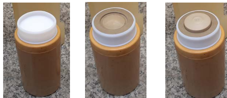
Frasco de decomposição com sistema de alívio de pressão
