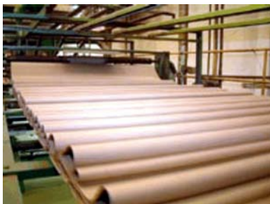
Figura 07 – papelão ondulado saindo da ondulateira
