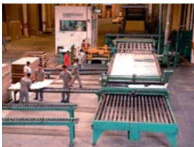
Figura 08 – Saída de chapas da ondulateira
