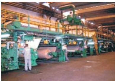
Figura 06 – Bobinas de kraft na ondulateira
