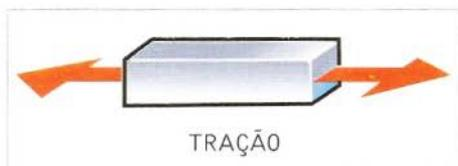
Em geral, a maioria dos materiais quando transformados para geometria fibrilar (forma de fibras) como cordas, cabos de aço, tecidos, tendem a aumentar seu desempenho quando submetidos a esforços de tração no seu sentido longitudinal.
