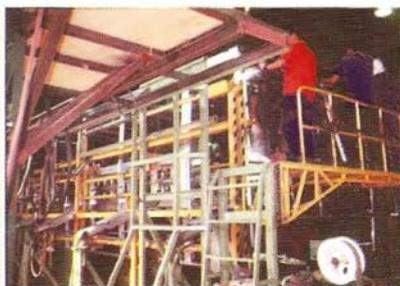
Exemplo de gabarito para montagem de estruturas de carroceria de ônibus
