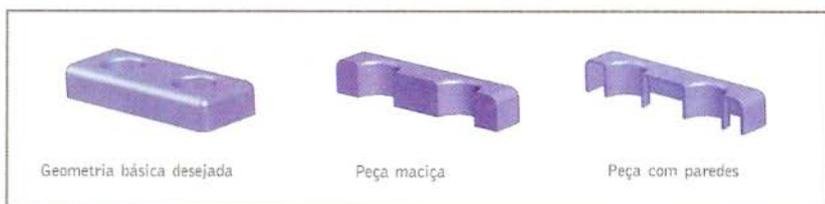
MUDANÇA DE ESPESSURA – muitas vezes faz-se necessário alterar as espessuras das paredes da peça em função de um encaixe, um ponto de fixação, um apoio etc. Quando isso ocorrer, a mudança de espessura deve ser suave para evitar problemas durante o processo (escoamento do material na cavidade da matriz e extração da peça) e marcas na superfície da peça.
