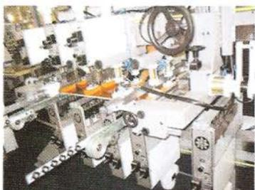
O primeiro grupo corresponde a equipamentos nos quais os cortes são executados por um tipo de serra circular que garante a perpendicularidade entre eles. A maioria dos equipamentos são de controle numérico e operam com plano de corte previamente determinado.
