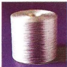
O *roving* é uma bobina cilíndrica de mechas de fios de fibra de vidro (como um carretel de linha) formando um material contínuo. Este material de características de reforço unidirecional é bastante empregado em processos de reforço por enrolamento (fabricação de encanamentos especiais, bicos de avião etc.) no processo de pultrusão (fabricação de perfis em resina poliéster) bem como em processos de laminação manual ou à pistola.
