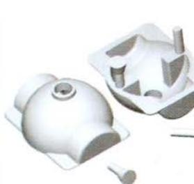
Após a moldagem da caixa superior e inferior, os modelos da peça, do canal de descida e do respiro são retirados, deixando vazias as cavidades superiores e inferior (sobre a qual é posicionado o macho). A caixa superior é então colocada sobre a inferior para que o metal fundido possa ser vertido (vazamento) pelo canal de descida até preencher por completo a cavidade.
