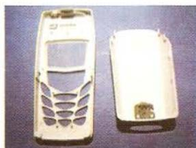
▫ **PC (polycarbonato) + ABS (Acrilonitrila Butadieno Estireno)** – o ABS como modificador contribui para melhoria do processamento, melhorar a resistência a reagentes e solventes e reduzir o custo sendo utilizada em carcaças de faróis, corpo de telefones celulares e outros equipamentos portáteis, carcaças de outros equipamentos que requeiram resistência
