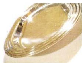
**AÇO INOXIDÁVEL** – é a combinação do aço carbono (0,03 a 0,15%) com o cromo na proporção de 11 a 20% o que lhe confere uma notável resistência à oxidação. O cromo nesta quantidade propicia, em contato com o oxigênio, o surgimento de uma fina camada de óxido de cromo em todo o contorno da peça que se recompõe mesmo se for interrompida algum risco ou corte, impedindo a oxidação do ferro. O aço Inoxidável pode ser encontrado em três famílias distintas:
