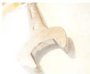
**AÇO CROMO** – é a combinação do aço carbono (0,15 a 0,30%) com o cromo, na proporção variando entre 2 a 4%. Em virtude de sua excelente estabilidade dimensional, a sua resistência à oxidação e à sua dureza, este tipo de aço é muito empregado para a confecção de moldes, ferramentas e instrumentos abrasivos.
