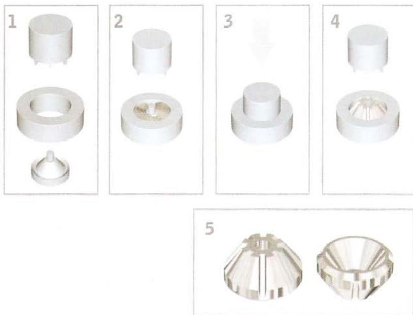
Sequência resumida do processo de sinterização
