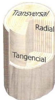
O **PLANO TANGENCIAL** é praticamente perpendicular ao plano transversal e ao plano radial. Por meio de sua observação, é possível verificar a superfície dos anéis de crescimento.
