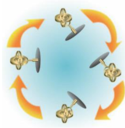
Figura 100: Independentemente da posição da sua base, um giroscópio tende a permanecer rígido no espaço, com seu eixo de rotação apontado em direção constante.
