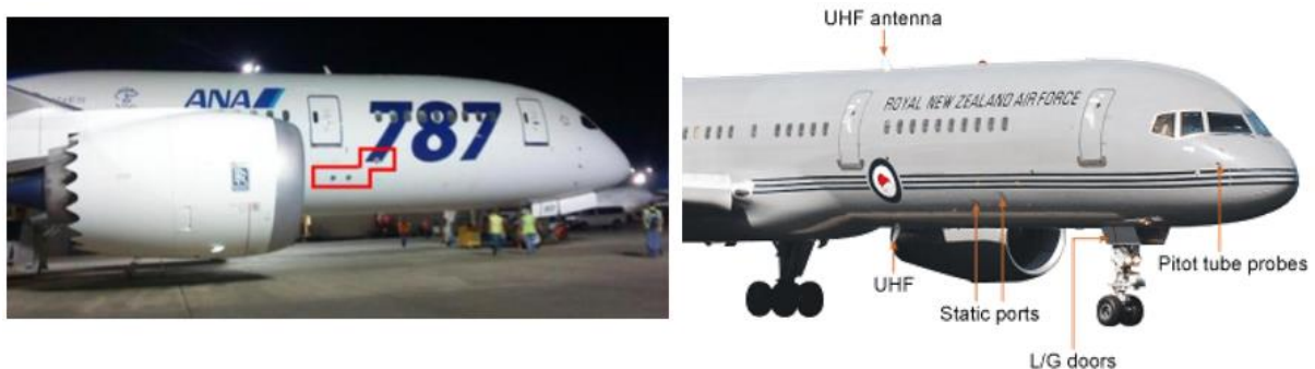
Figura 90: Tomadas estáticas instaladas nas laterais dos aviões
