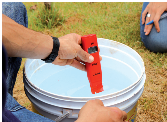
Figura 14. Aferição do pH com peagâmetro digital.
