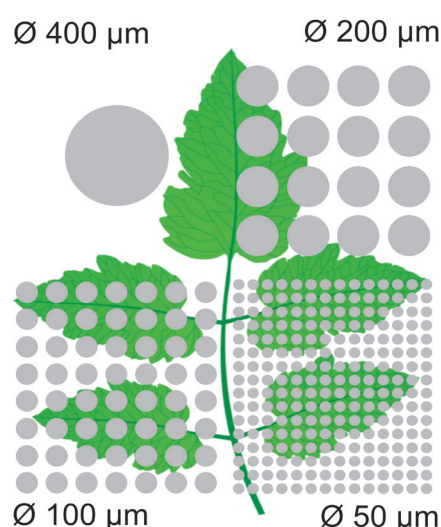
Figura 7. Influência do tamanho das gotas no recobrimento foliar.
