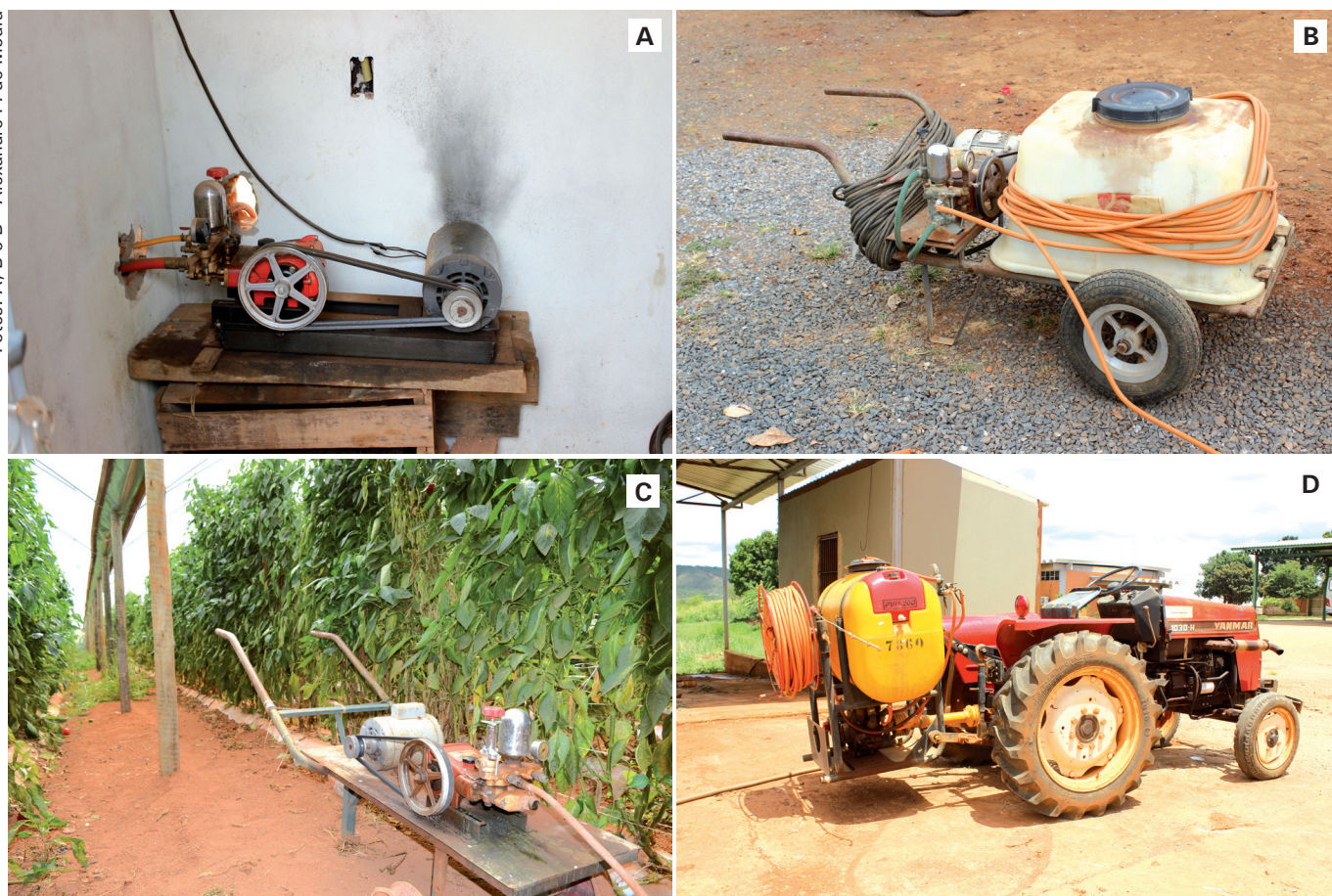
Figura 3. Pulverizadores motorizados: estacionário (A), portátil com (B) ou sem reservatório acoplado (C) e de engate (D).
