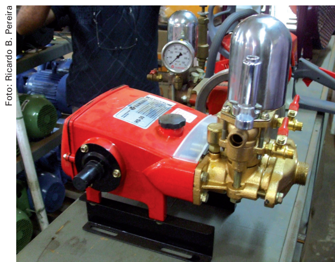
Figura 5. Bomba de pistão utilizada em pulverizadores motorizados.
