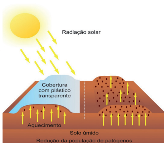
Figura 8. Esquema ilustrativo da solarização do solo, indicada para a redução da população de patógenos do solo.
