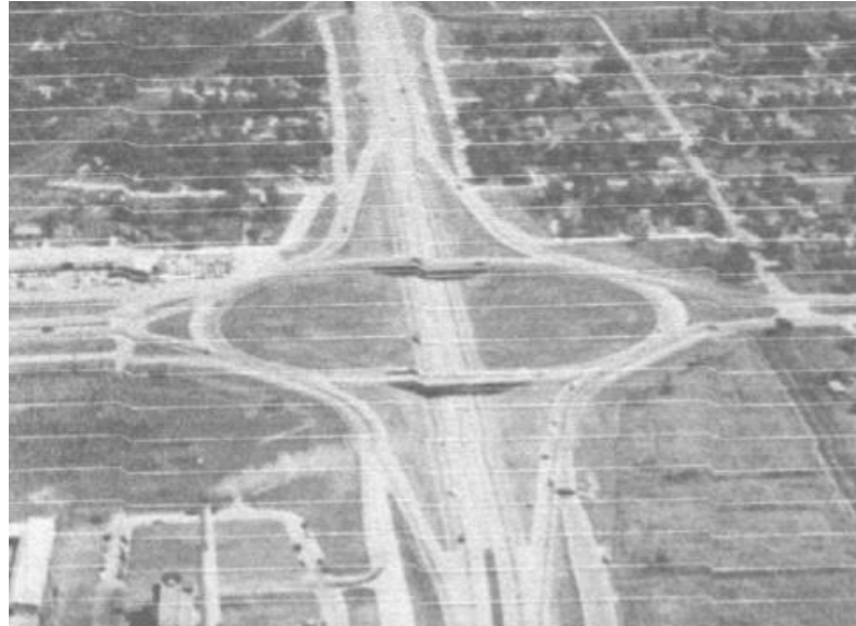
Figura 2.5 - Interconexão do tipo Giratório
