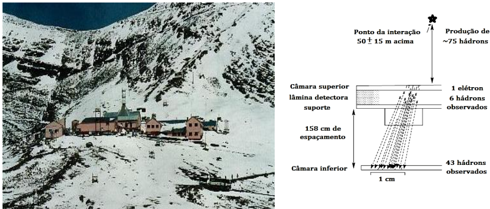
Fig. 12.9. Esquerda: o laboratório de Chacaltaya na Bolívia. Durante o inverno a neve impossibilitava a coleta de dados nas emulsões das câmaras. Direita: esquema do experimento e o evento Centauro, assim chamado por parecer uma coisa na câmara superior e outra diferente na inferior. O mais notável é que não houve nenhuma detecção de fótons, e assim a cascata eletromagnética "normal" ficou descartada.
