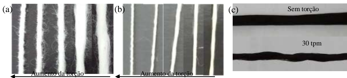
Figura 1 – Efeito da torção nos fios de algodão (a), para-aramida(b) e carbono (c).
