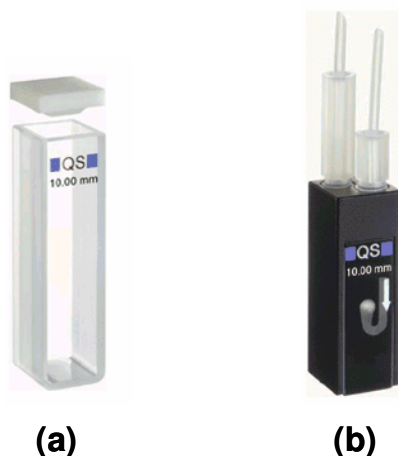
Figura 11. Cubetas retangulares com 10 mm de caminho óptico: (a) convencional e (b) para medidas em fluxo.
