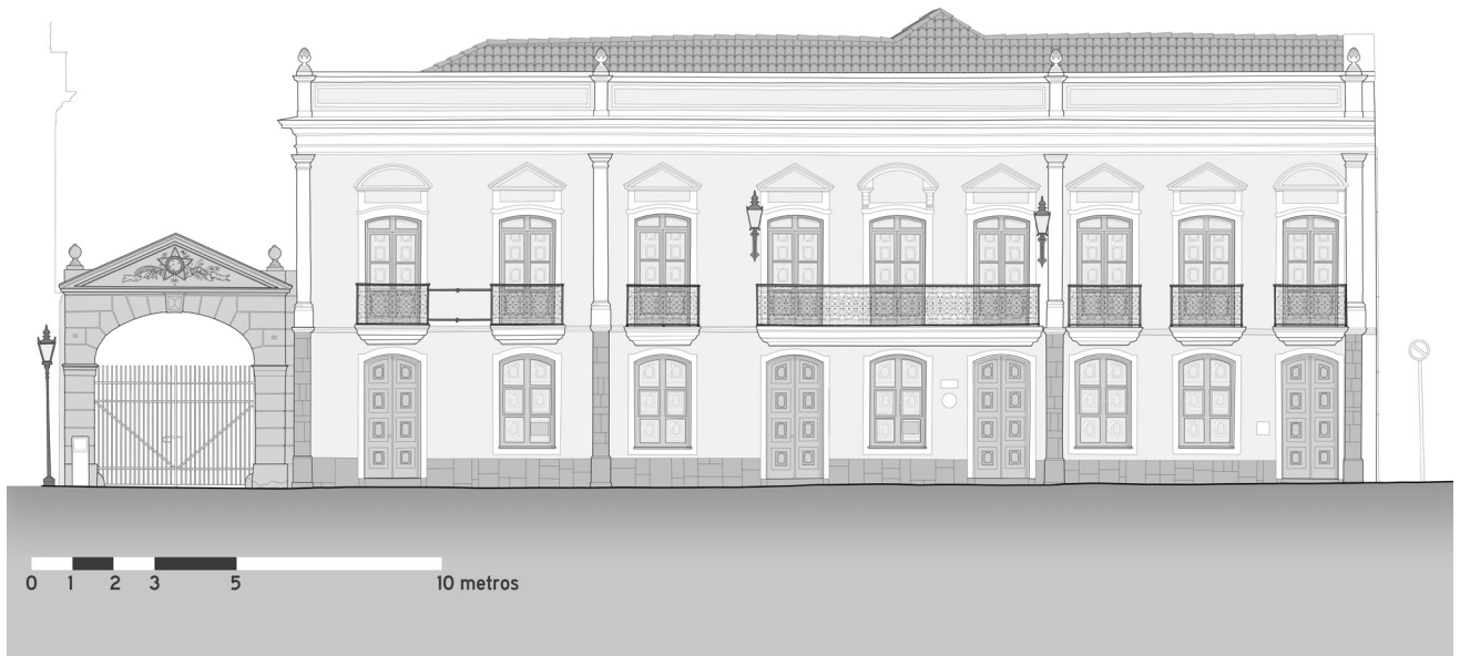
> FACHADA PRINCIPAL EM 1863 E EM 2019 Observar nessas imagens a diferença na visibilidade do telhado, antes e depois da platibanda.
