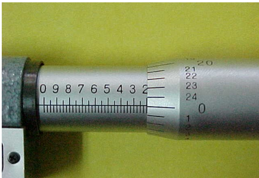
Figura 3.3 – Parafuso micrométrico graduado de um micrômetro simples.
