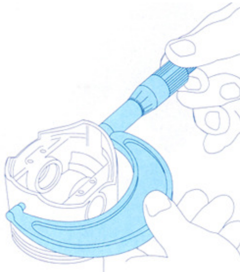
Figura 3.4 – Realizando uma medida com um micrômetro simples.
