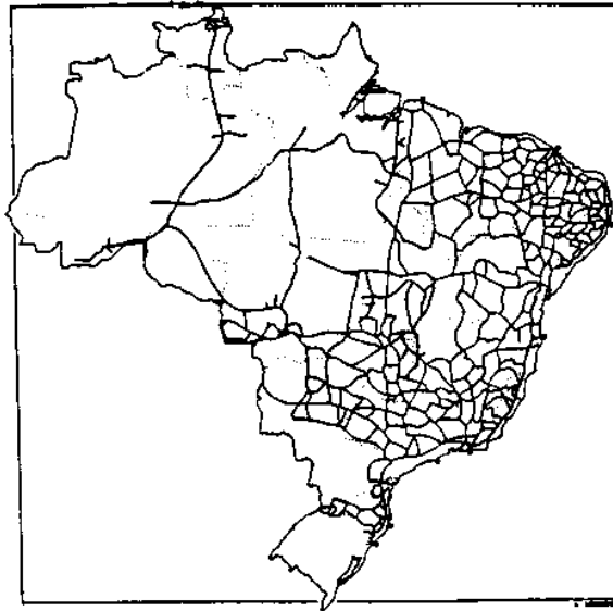
Figura 1.4 - Rede de nivelamento geodésico executado pelo IBGE
