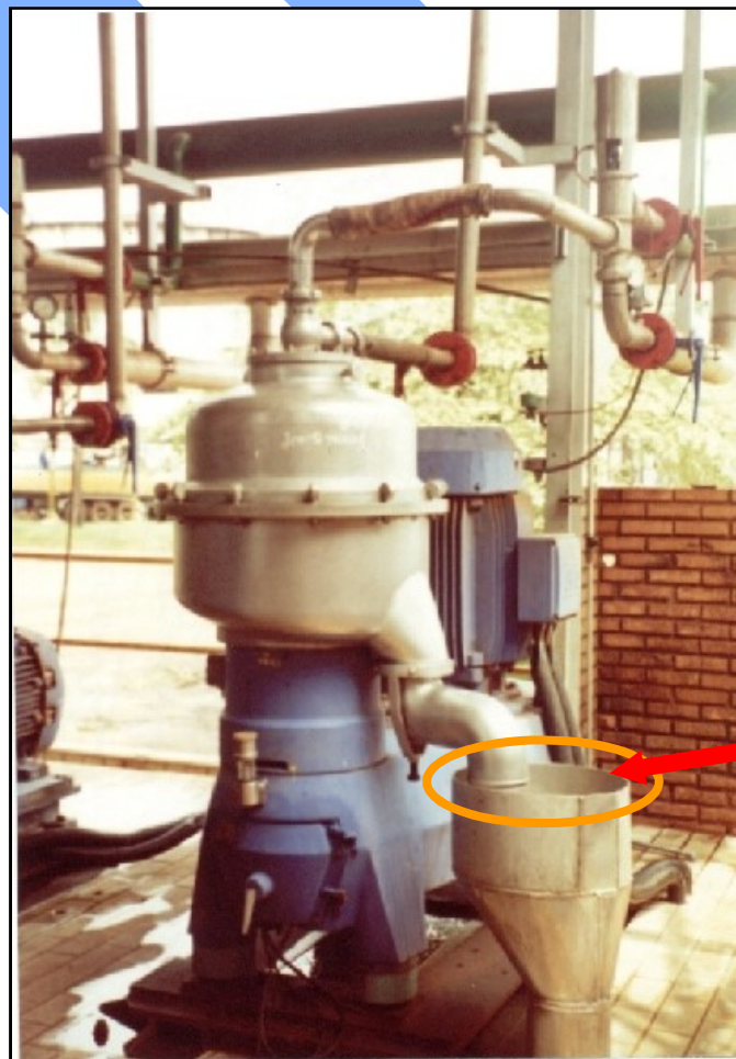
Centrifuga separadora do levedo do vinho - saída do vinho por pressão pelo centro superior -
