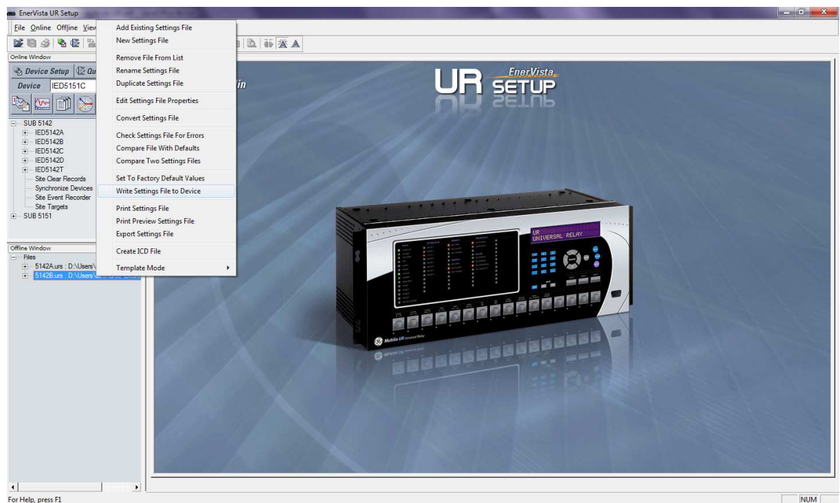
Fig. 17.1: Transferindo as configurações de um arquivo offline no computador para a memória de um IED de campo.
