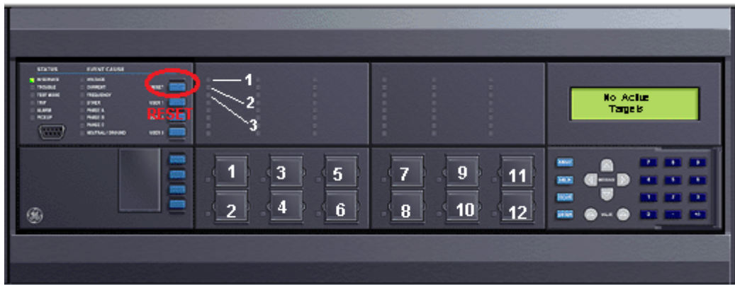
Figura 4.3 – Localização dos botões frontais, LEDs e do botão RESET.
