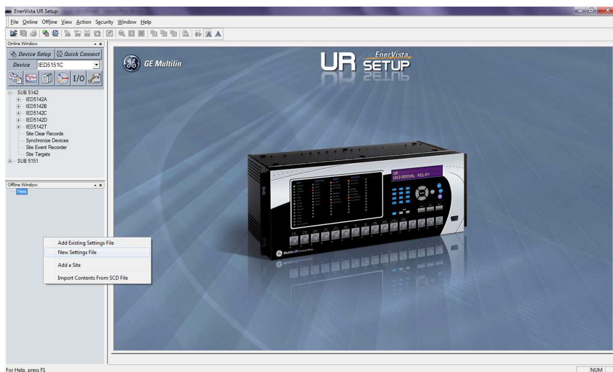
Fig. 18.1: Criando um arquivo offline para armazenar as configurações do IED.
