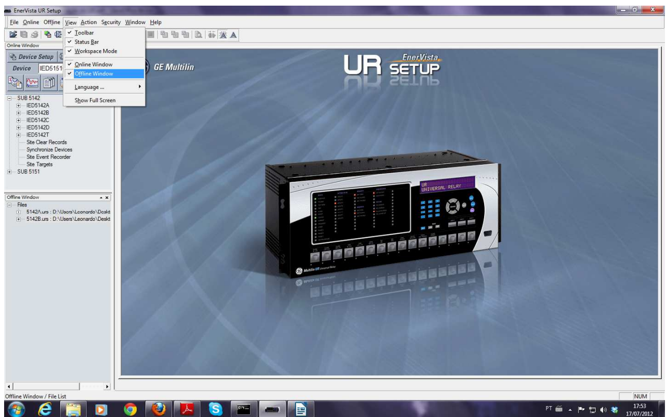
Figura 2.2: Configurando a exibição da janela "Offline Window" no Enervista.
