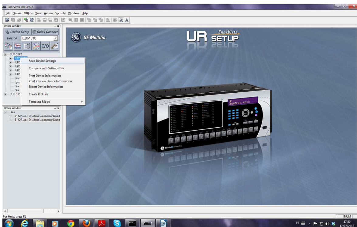
Figura 16.1: Fazendo a leitura das configurações de um IED presente na rede para um arquivo offline “.urs”.
