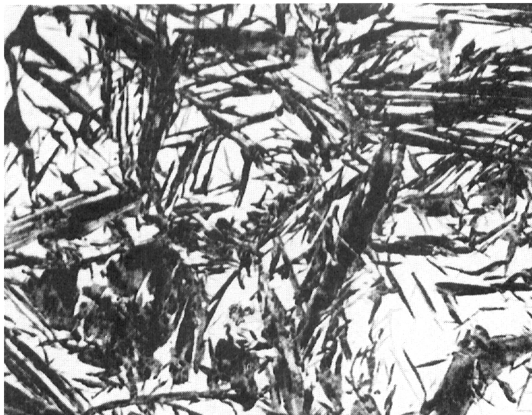
Plaquetas de martensita em um fundo de austenita retida.
