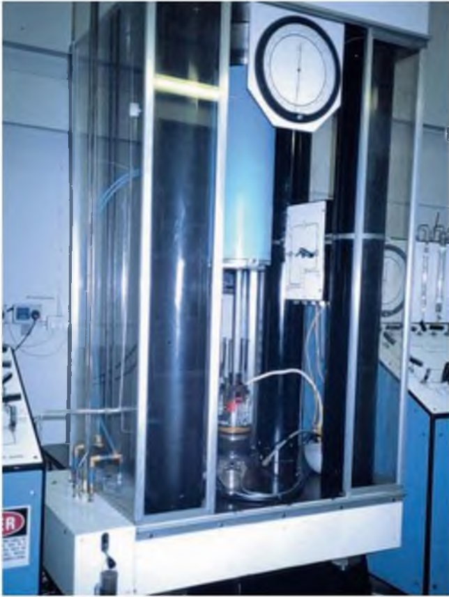
Figura 3.58 Máquina servo-controlada para ensayos de compresión (foto M. Ferrer).
