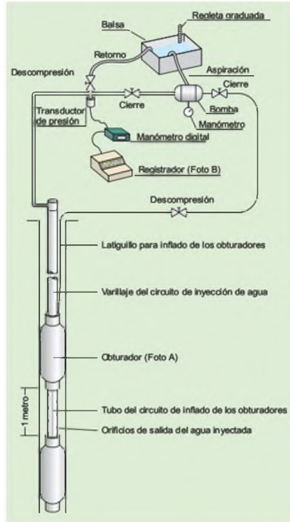
Figura 3.131 Dispositivo utilizado en el ensayo de fracturación hidráulica del ejemplo del Recuadro 3.13.
