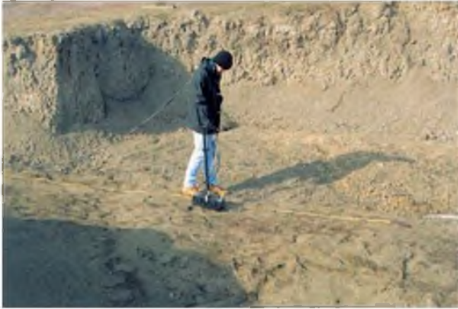
Figura 6.41 Aplicación del geo-radar en campo (foto A. Muñoz).
