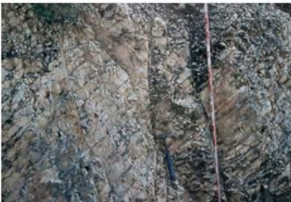
Cuarcitas ordovícicas. Calidad mala. Macizo alterado y brechificado.
