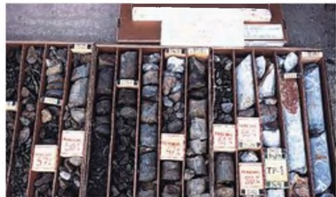
Figura 6.31 Caja portatestigos de sondeo geotécnico en rocas (foto L. González de Vallejo.)
