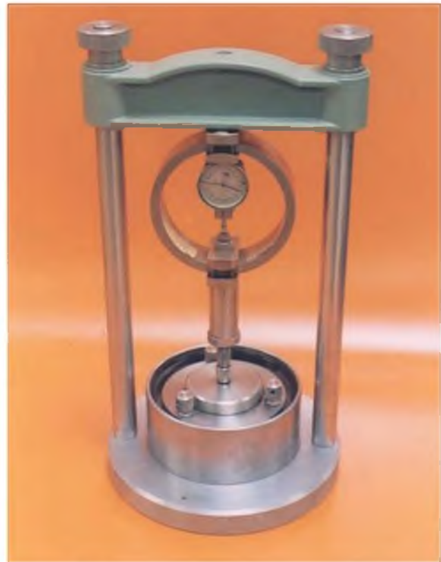
Figura 2.94 Aparato de Lambe para caracterizar la expansividad de los suelos (foto C. Oteo).
