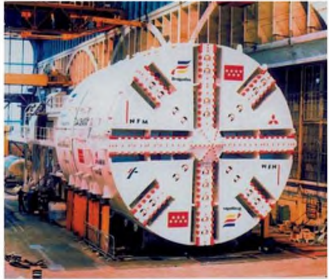
Figura 10.33 Tuneladora «La Chata» utilizada en el Metro de Madrid (cortesía de la Comunidad de Madrid).
