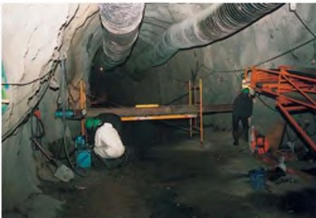
Figura 6.81 Dispositivos e instalación del ensayo de placa de carga en roca (cortesía de In Situ Testing).
