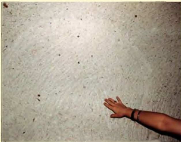
Matriz rocosa intacta isotropa y homogénea a escala macroscópica. Toba volcánica.
