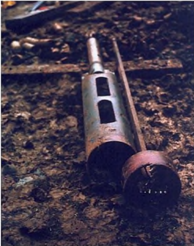
Figura 6.19 Cuchara de extracción para testigos en sondeos a percusión (foto L. González de Vallejo.)
