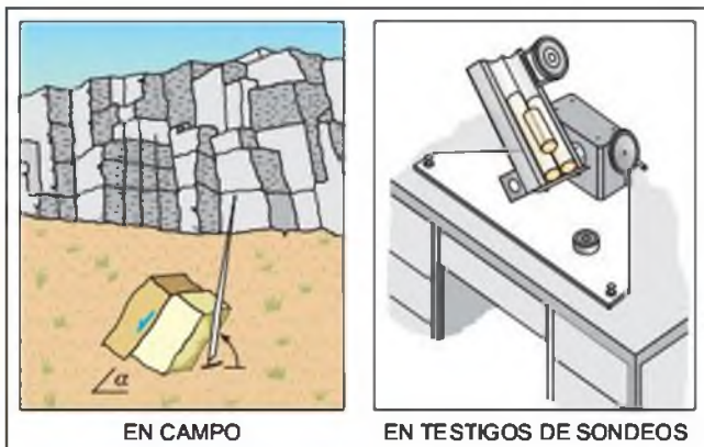
Figura 6.73 Ensayo de tilt test (Barton, 1981).
