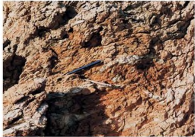
Figura 3.5 Material arcilloso muy alterado con características comunes de las rocas y los suelos.
