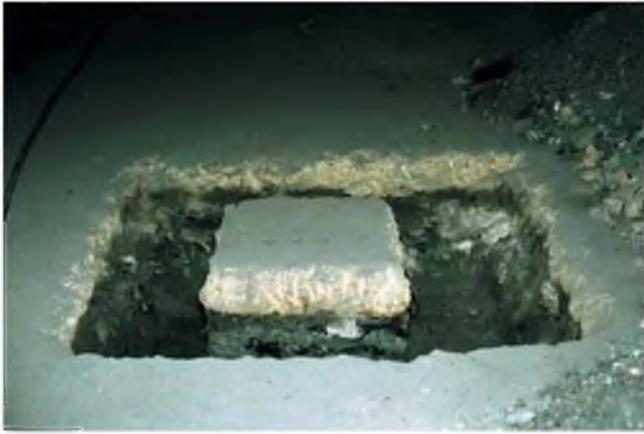
Figura 6.72 Ensayo de corte in situ en rocas (cortesía de In Situ Testing).
