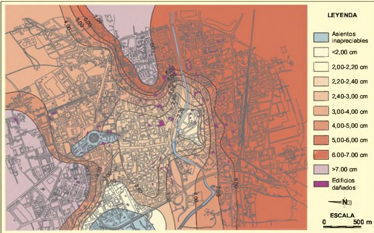
Mapa de asentamientos estimados en la ciudad de Murcia por subsidencia provocada por descenso del nivel freático (cortesía del IGME y COPOT, Región de Murcia)
