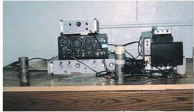
Figura 3.65 Aparato para el ensayo de velocidad sínica (foto L. G. de Vallejo).
