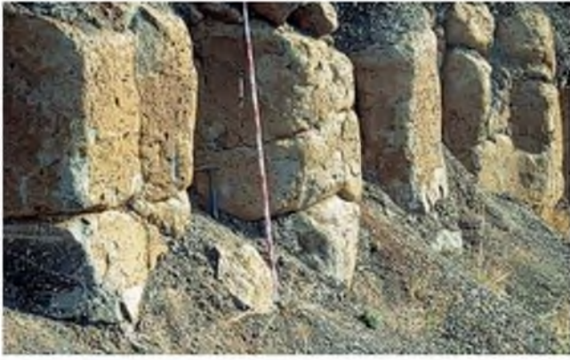
Figura 3.17 Alteración a suelo de un macizo rocoso volcánico a favor de los planos de fractura (cortesía de Prospección y Geotecnia).
