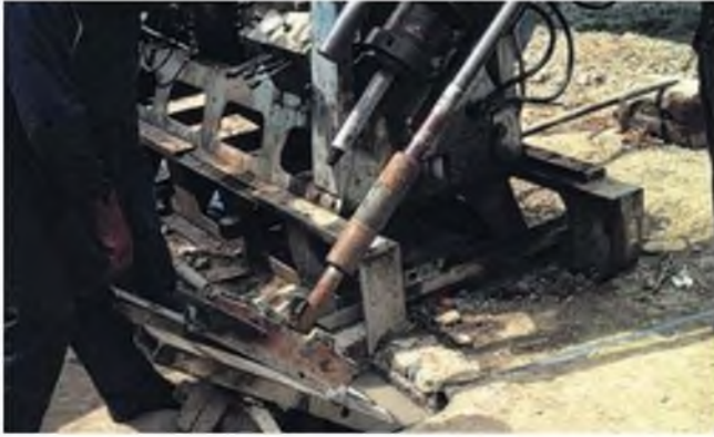
Figura 6.88 Obturadores y baterías para el ensayo de permeabilidad Lugeon (foto L. González de Vallejo).
