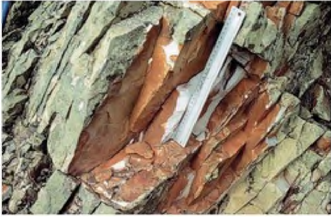
Figura 4.14 Alteración por oxidación en las superficies de discontinuidad de un macizo rocoso de cuarcitas, mientras que la matriz rocosa permanece fresca.
