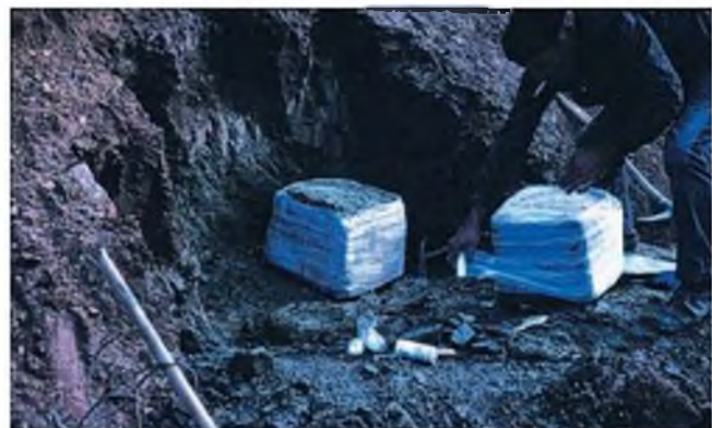
Figura 6.28 Muestras en bloque y protección de las mismas (foto L. González de Vallejo).
