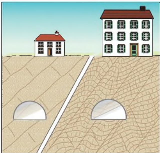
Figura 3.3 Dimensiones de las obras de ingeniería con respecto a la estructura del macizo y a la separación entre discontinuidades.
