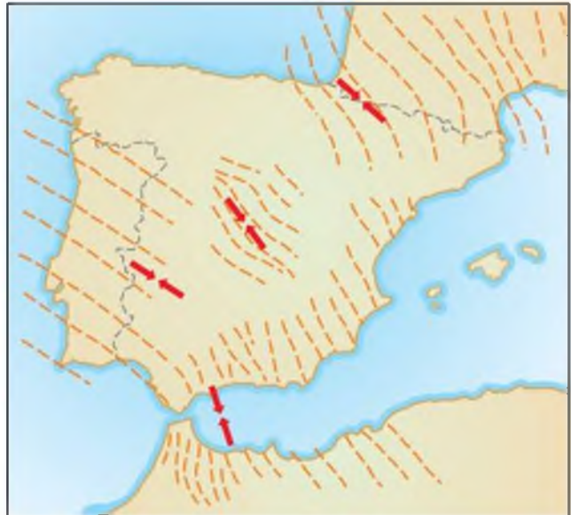
Figura 10.9 Direcciones de los esfuerzos tectónicos principales en la Península Ibérica (modificado de Giner, 1996).
