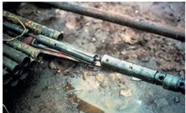
Figura 6.15 Sistema de wire line (foto L. González de Vallejo).
