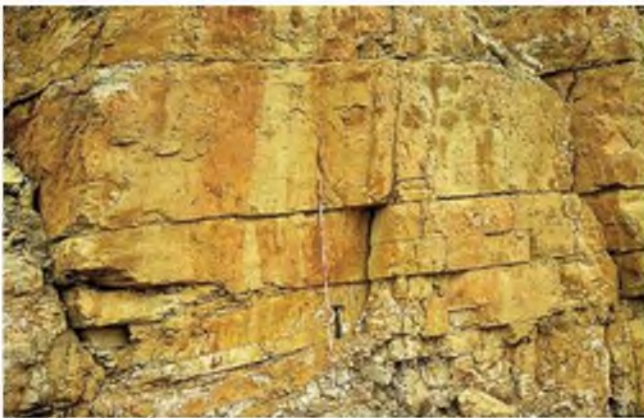
Figura 3.72 Superficies de estratificación horizontales de gran continuidad en un macizo rocoso calizo (cortesía de Prospección y Geotecnia).
