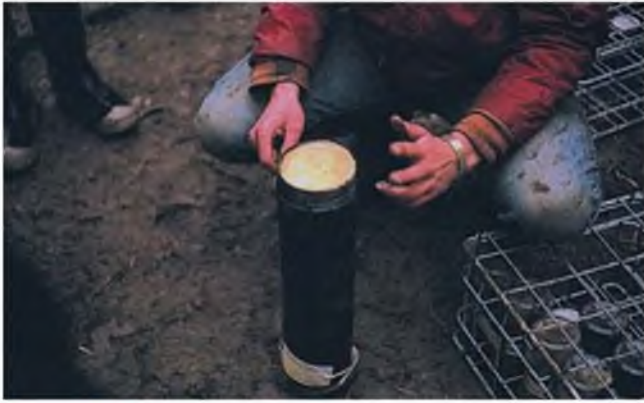
Figura 6.29 Parafinado de muestras obtenidas en calicatas por hincada de tubo (foto L. González de Vallejo.)
