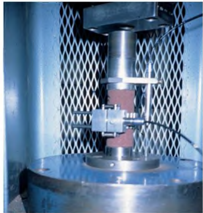
Figura 3.52 Probetas preparadas para el ensayo de compresión simple, con bandas extensométricas y comparadores para la medida de las deformaciones axial y transversal o radial (fotos M. Ferrer).
