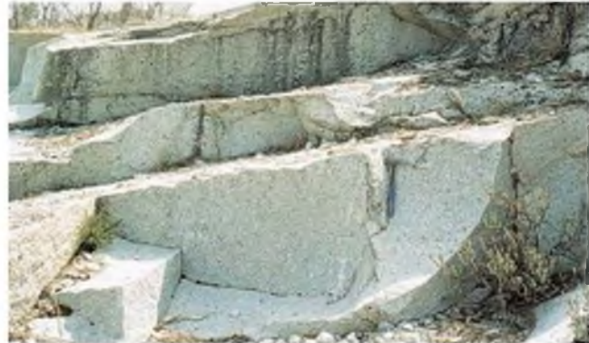
Figura 3.16 Fracturas de decompresión en un macizo rocoso granítico paralelas a la superficie (cortesía de Prospección y Geotecnia).
