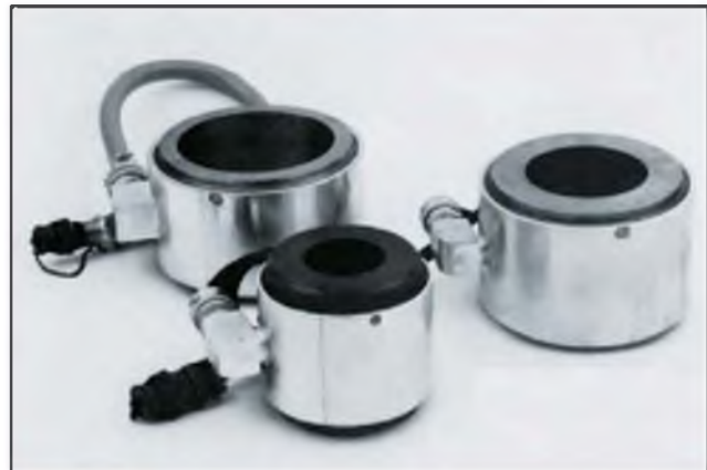
Figura 6.103 Célula de carga de cuerda vibrante (cortesía de Ingeniería de Instrumentación y Control, IIC).
