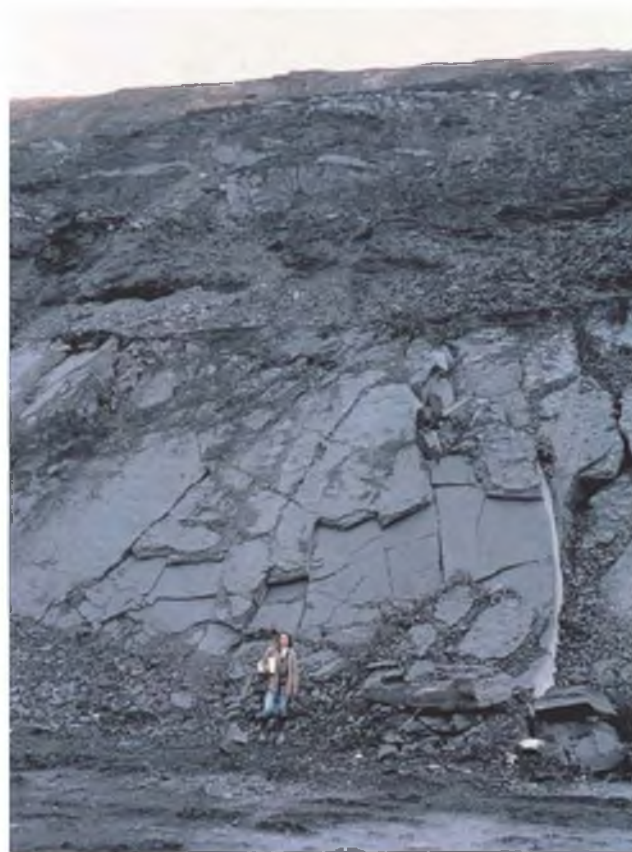
Figura 9.24 Pandeo de estratos en materiales lutíticos con rotura de las placas de roca en su base, Peñarroya, Córdoba (foto L. González de Vallejo).
