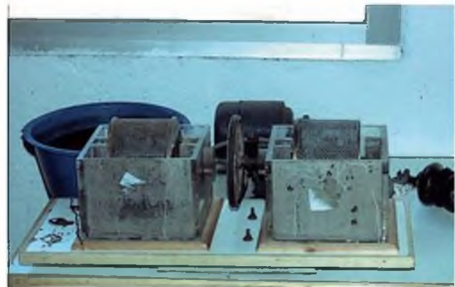
Figura 3.8 Aparato para el ensayo de sequedad-humedad-desmoronamiento SDT, slake durability test (foto L. G. de Vallejo).
