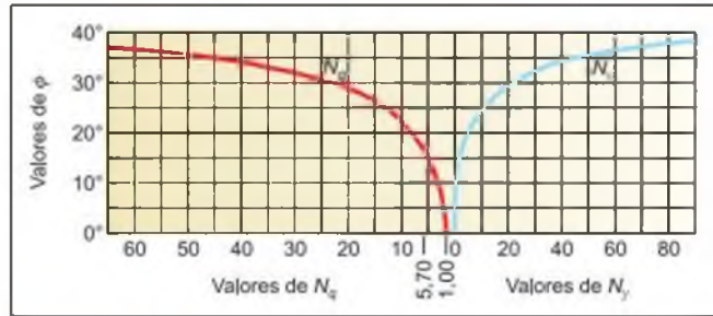
Figura 8.31 Factores de capacidad de carga.
