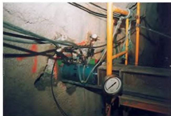
Figura 6.81 Dispositivos e instalación del ensayo de placa de carga en roca (cortesía de In Situ Testing).
