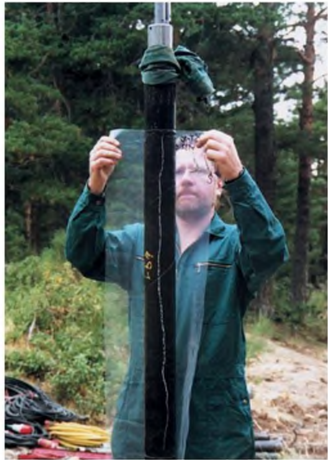
Figura 3.130 Impresión de fracturas registrada en el sondeo (cortesía de In Situ Testing).
