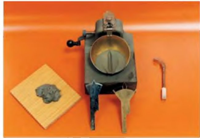
Figura 2.5 Cuchara de Casagrande para determinación del límite líquido. Se observa la arcilla amasada y colocada sobre la cuchara con el canal ya abierto. También pueden verse tres tipos de acanaladores usados en la práctica.
