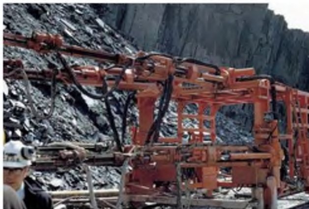
Figura 10.18 Carro perforador de cuatro brazos (foto L. González de Vallejo).
