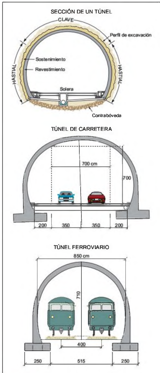
Figura 10.2 Secciones típicas de túneles y sus denominaciones.
