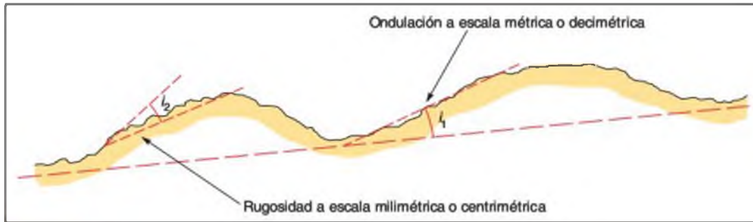
Figura 4.10 Ondulación y rugosidad de una superficie de discontinuidad.
