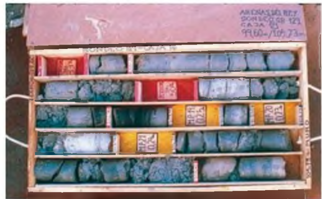
Figura 6.30 Caja portatestigos de sondeo geotécnico en suelos (foto L. González de Vallejo.)
