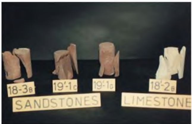
Figura 3.53 Probetas rotas a compresión simple (fotos M. Ferrer).
