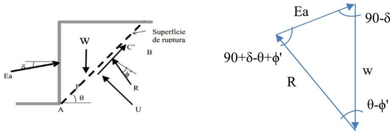
**Ea** - empuxo ativo por unidade de comprimento. A direção de  $E_a$  é inclinada com um ângulo  $\delta$  em relação à normal à face do muro que suporta o solo.  $\delta$  é o ângulo de atrito entre o solo e o muro.
