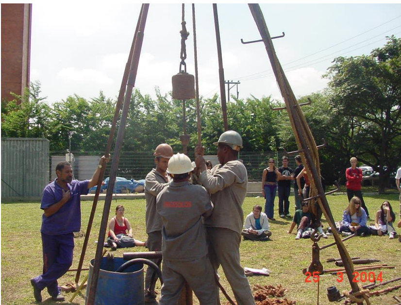
Figura 2.4a – Execução do ensaio de SPT
