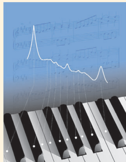
Dez dos 12 tons da escala cromática e seus correspondentes no teclado de um piano. A função que aparece sobre o teclado indica que esses tons correspondem estatisticamente aos picos normalizados de potência de fala humana.
