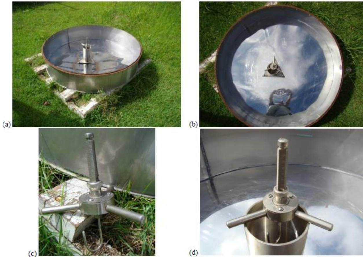
Tanque Classe A. (a) Tanque em cima de pallet visto de perspectiva. (b) Tanque visto de cima. (c) Parafuso micrométrico com ponta em forma de gancho. (d) Parafuso micrométrico dentro de poço tranquilizador.
