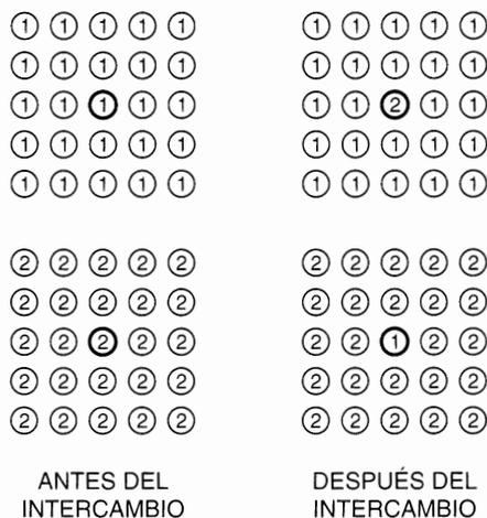
**Figura 7.8** Significado físico de la energía de intercambio. La energía absorbida en el proceso es  $2w$ . [Véase la Ecuación (7.71)].
