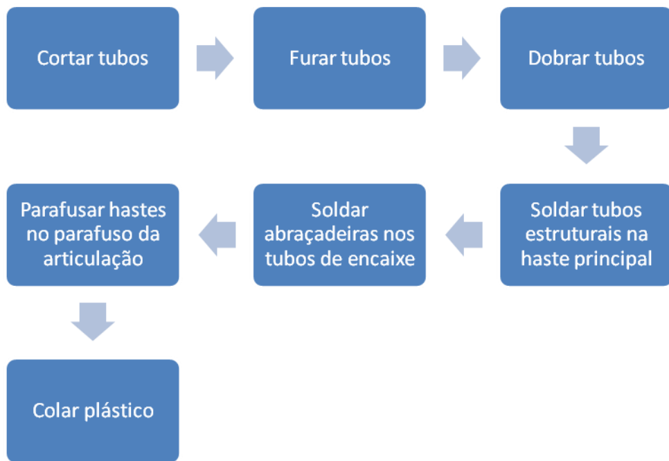
Figura 28 – Fluxograma do processo da solução nova
