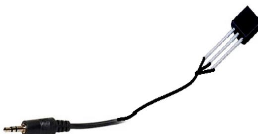
**Figura 4.3.15: Esquema ilustrativo do sensor de temperatura acoplado ao conector.**
