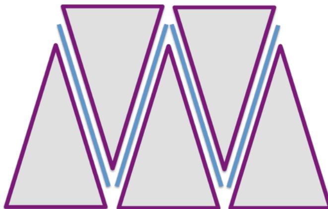
**Figura 12.4.6: Representação esquemática da disposição das embalagens individuais dos produtos dentro da embalagem de contenção**
