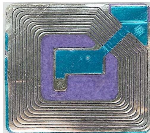
**Figura 20: Etiqueta de RFID inserida
