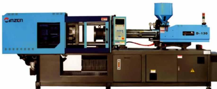
Figura A13.2: Foto da máquina injetora.
