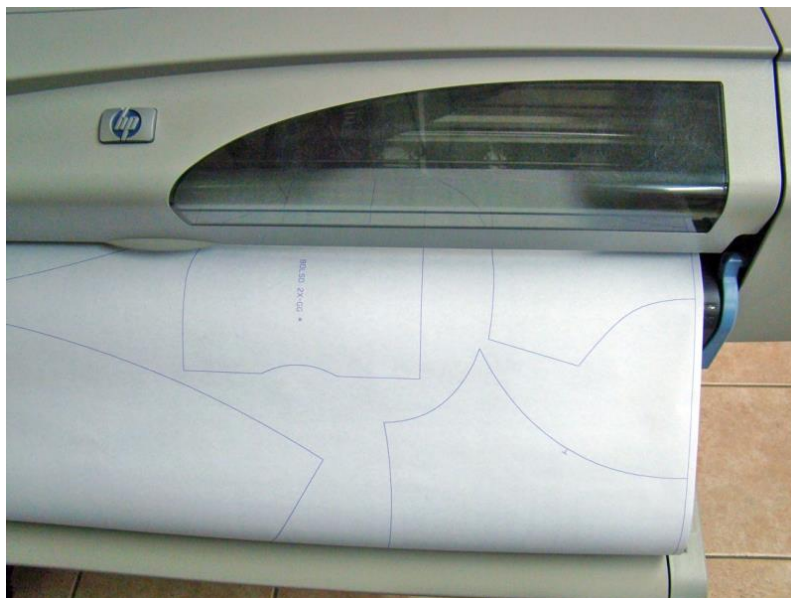
Figura 36 - Exemplo de risco saindo pronto de uma máquina impressora específica, indicando integração com programa CAD
