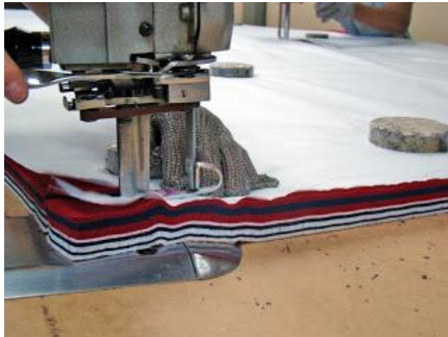
Figura 37 - Exemplo de diferentes camadas de tecido enfestadas
