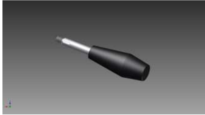
Figura 16: alavanca para movimentação do mecanismo selador.
