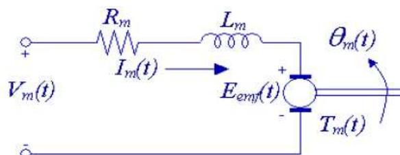
Figura 1.1: Diagrama eletromecânico do motor CC.
