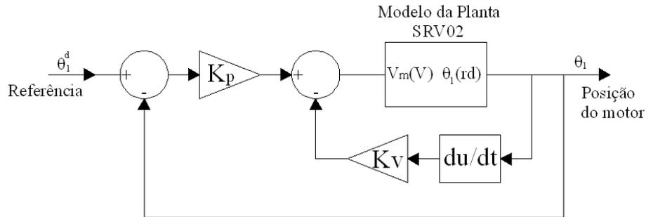
Figura 1.2: Diagrama de blocos do sistema em malha fechada com controlador PV.
