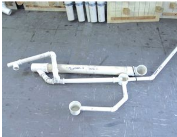
2. Ramais de esgoto
