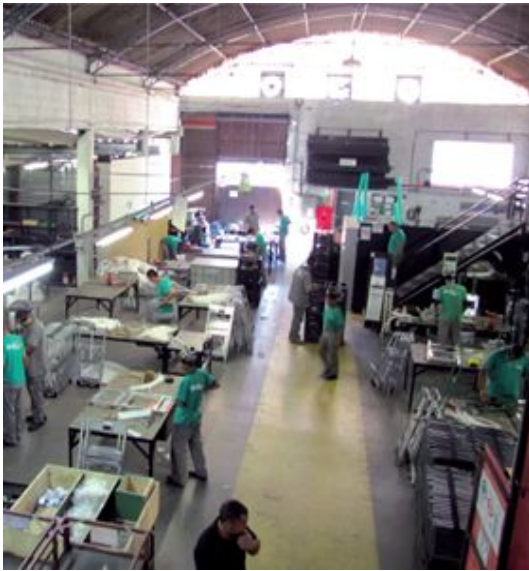
Galpão de montagem de kits. Nas bancadas, o material é separado e cortado para que, depois, sejam feitas as ligações e soldagens
