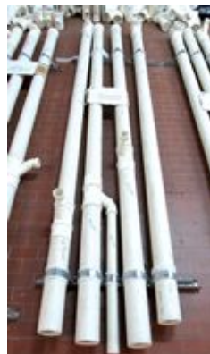
As conexões tornam a tubulação montada em kits mais sensíveis do que o material não beneficiado. Por isso, deve-se tomar mais cuidado com seu armazenamento e seu transporte até o momento da instalação
